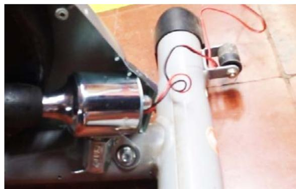
**Figura 2.** Montaje del generador de electricidad (dínamo)
